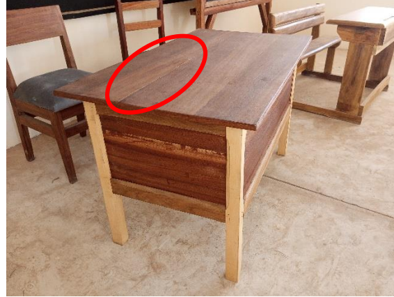
Photo 8 : Défaut de placage de table-maitre
